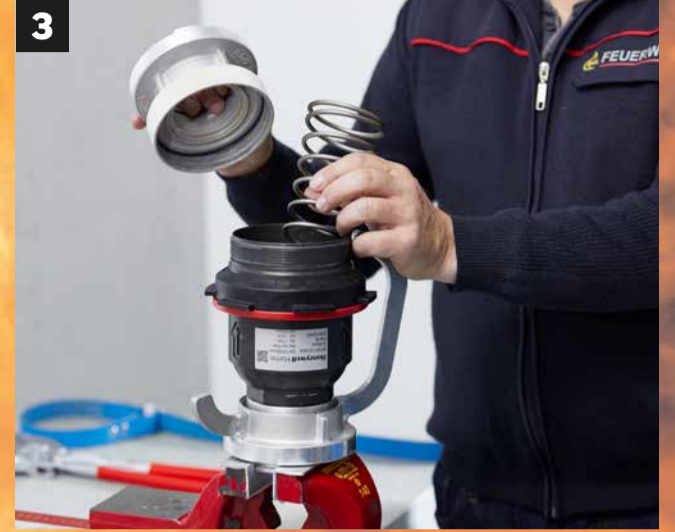
3 Spannungsfreie Feder entfernen
