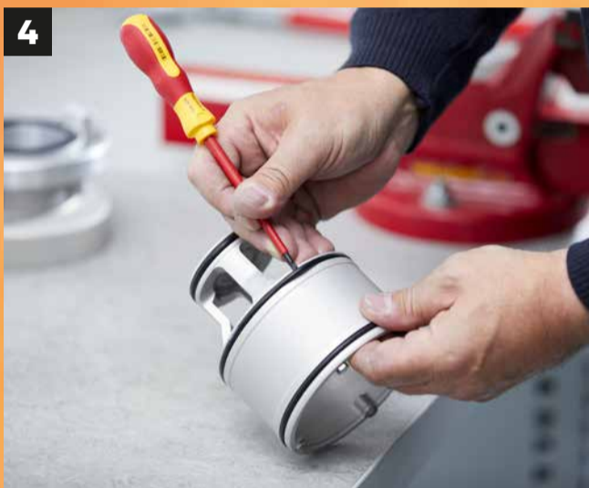
4 O-Ringe prüfen und ggf. mittels Schraubendreher entfernen
