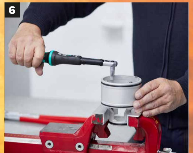
6 Kolben vorsichtig in Schraubstock einspannen und 4 Schrauben lösen
