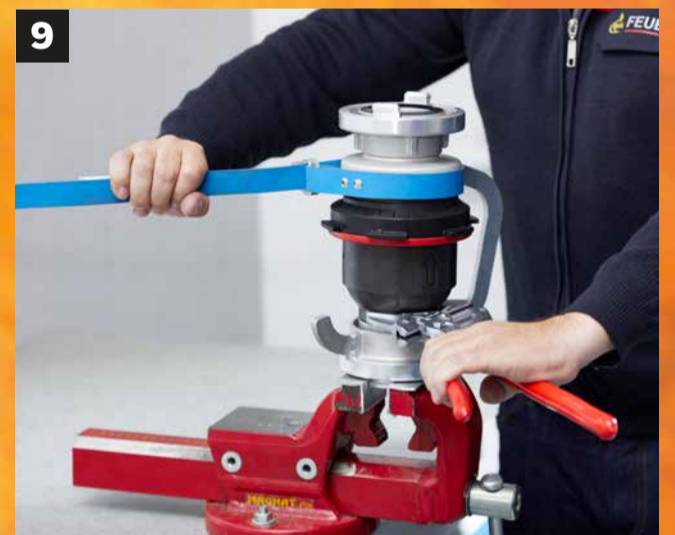
9 Deckel verschrauben und Systemtrenner mit TKA112 Prüfset testen
