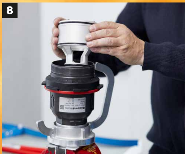
8 Kolben und Feder wieder einsetzen
