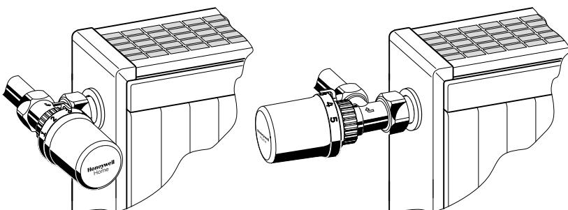
De asemenea, robinetul de colț dreapta V2036RSX poate fi rotit pentru utilizarea în instalația de colț stânga. Similar, robinetul de colț stânga V2036LSX poate fi rotit pentru utilizarea în instalația de colț dreapta.
